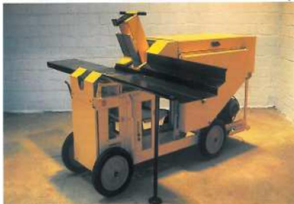
La construction et la conception permettant l'emploi de main d'œuvre peu qualifiée et l'entretien aisé par des artisans locaux peu outillés. Ce matériel répond à un usage intensif, à une utilisation maladroite, aux contraintes climatiques (chaleur, humidité et vents de sable). Le volant d'inertie permet d'obtenir une poussée de 15.000kg avec seulement un moteur de 3CV ou diesel de 4.5CV. Elle accepte les moules interchangeables aux dimensions selon vos dimensions avec un maximum de
