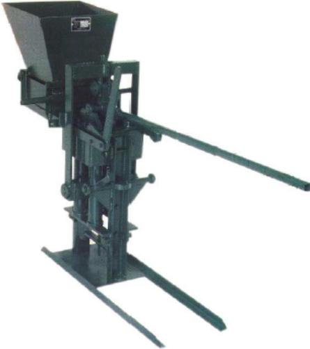
L'un des points forts des machines Titan est la force de la compression exercée sur la masse introduite dans le moule, bien qu'elles soient manuelles, grâce à leur embiellage qui multiplie par 220 la force exercée par l'Opérateur sur le levier.
